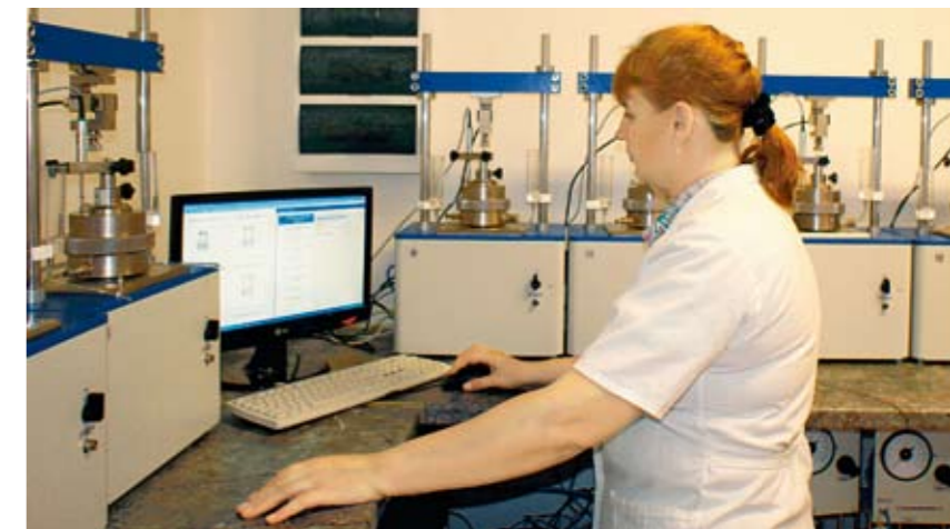
Грунтовая лаборатория, оснащенная современным автоматизированным испытательным комплексом «АСИС».
