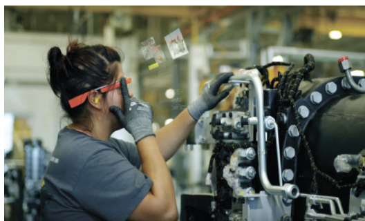
Рисунок 6. Использование дополненной реальности на сборочных участках современного машиностроительного производства
